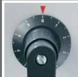
La manivela manual calibrada y la cinta métrica del tope lateral garantizan una alineación exacta de la escuadra trasera.
