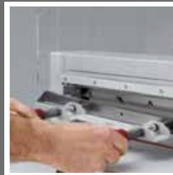
Fácil cambio de la cuchilla sin tener que retirar las tapas. Dispositivo para cambio de cuchilla con protección en el filo.
